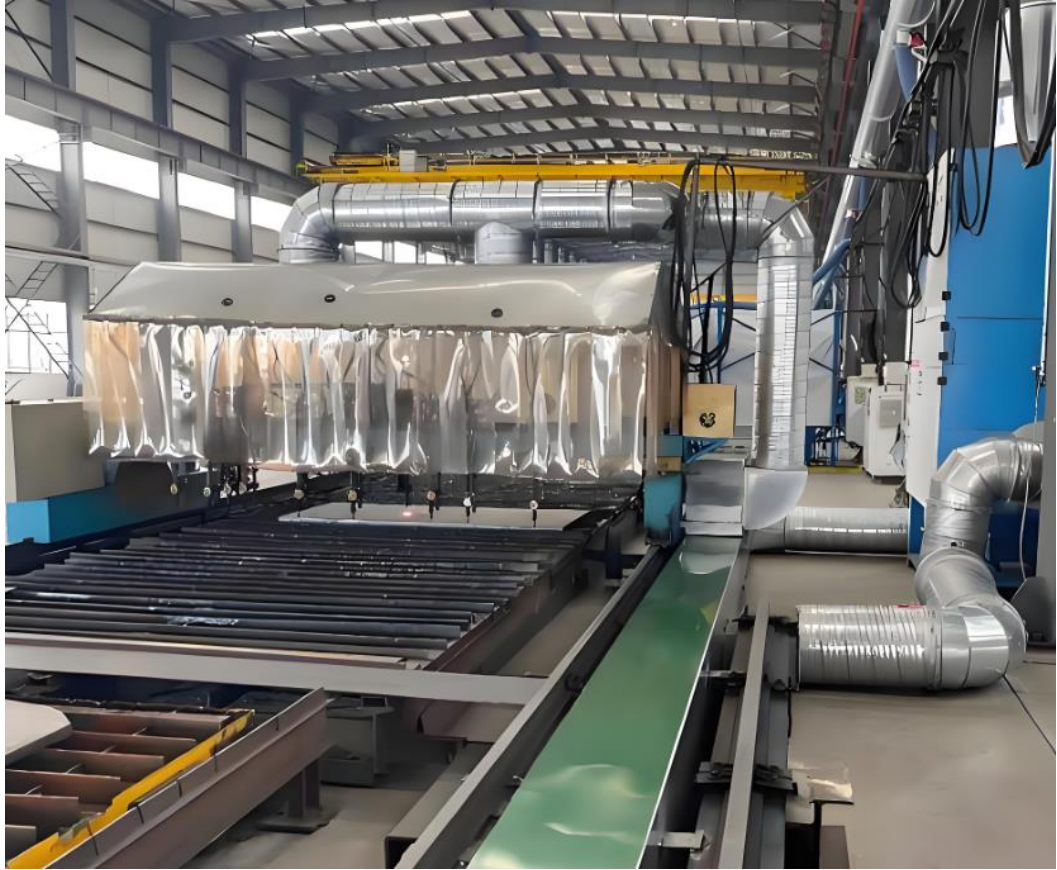
图 4 同类型企业火焰切割及激光切割可移动集气罩示意图
