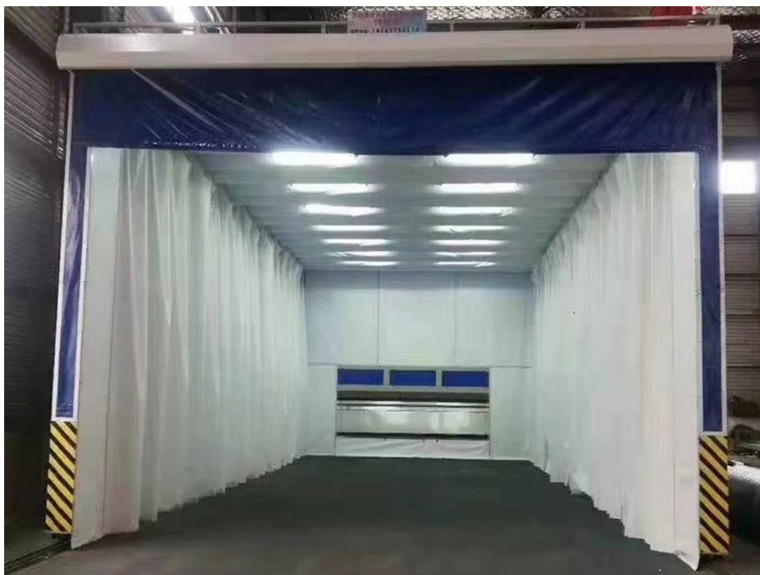
图 3 同类型企业可移动式密闭喷漆房示意图
