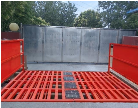
现有工程车辆冲洗装置
