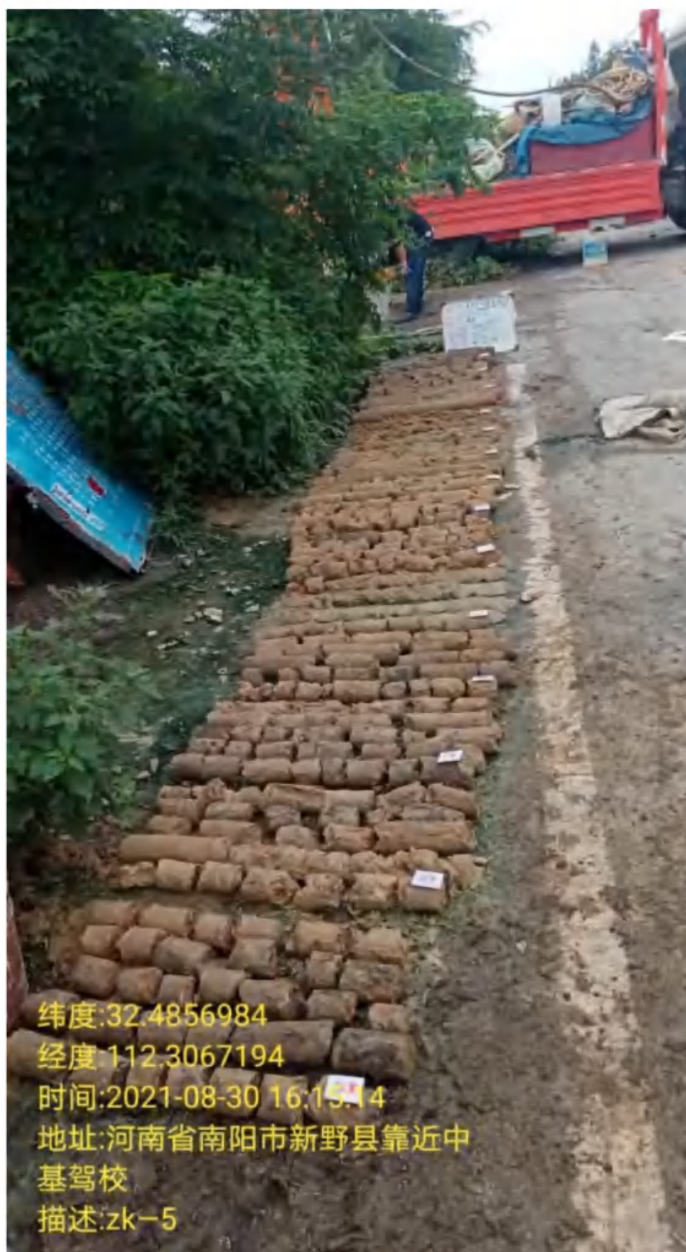
图 10 工程场地 5 号钻孔现场工作照
